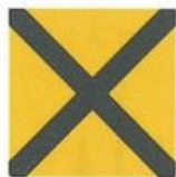
Skilt for feil retning
